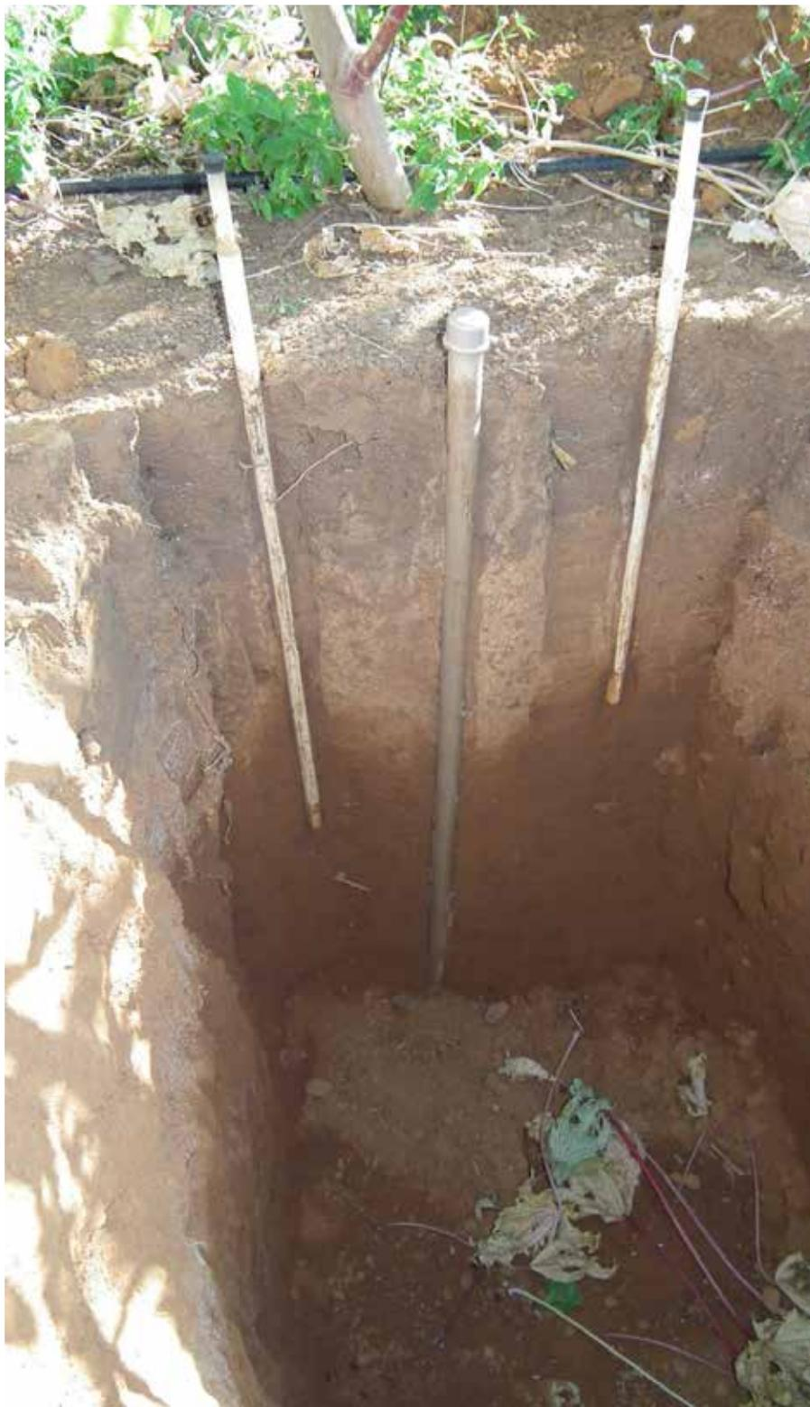
**Figura 3.** Instrumentação para o monitoramento da água no solo (tensiômetros nos lados e, no centro, tubo de acesso à sonda de capacitância). Fonte: Alexsandro dos Santos Brito, 2018.
