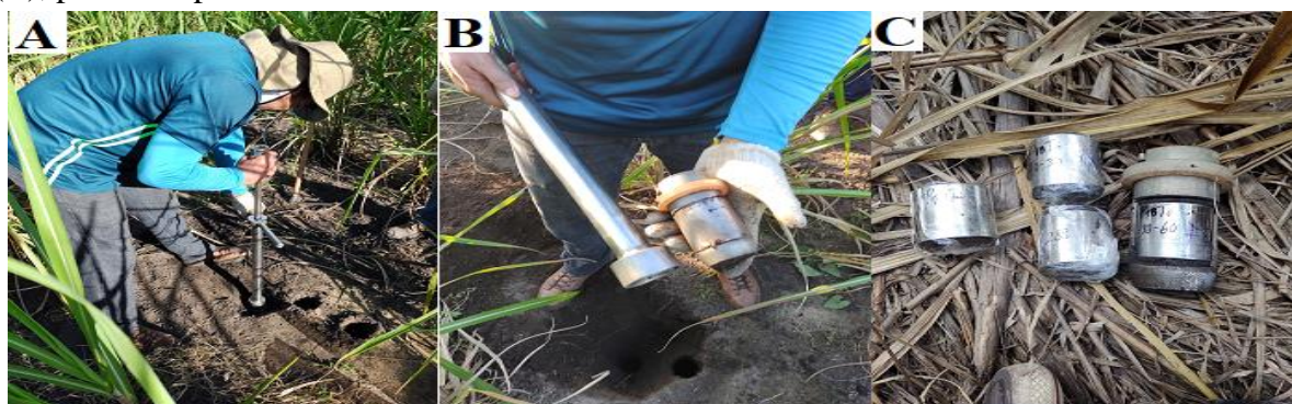
Figura 3 – Coleta de amostras utilizando amostrador tipo Uhland (A); desacoplamento entre o cachimbo e o amostrador (B); conjunto cilindro-amostra no cachimbo e amostras embaladas (C), para transporte ao laboratório.
