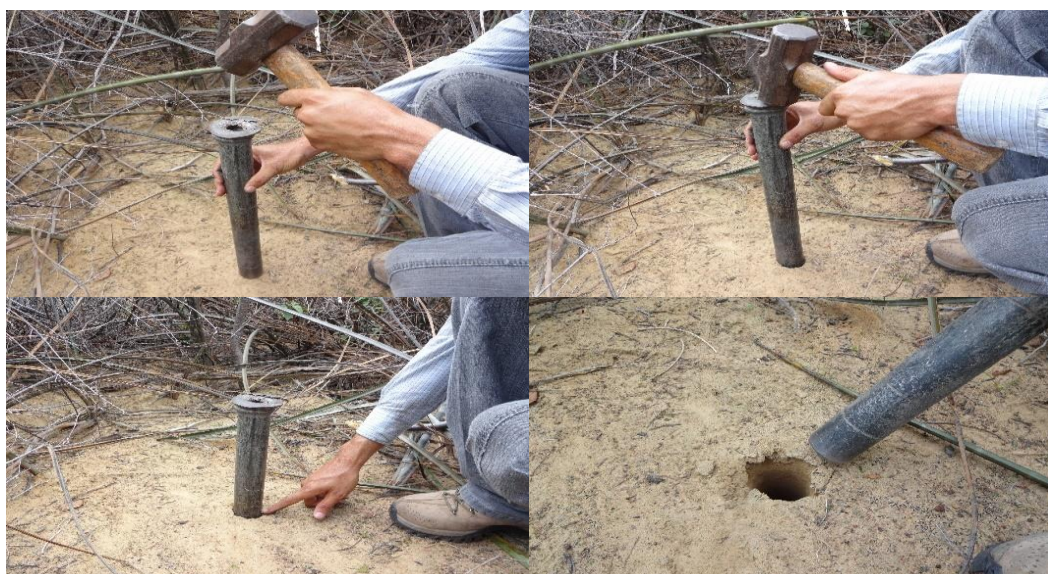
Figura 1: Coleta de solo no horizonte superficial (camada de 0-20 cm) para análises química e granulométrica.
