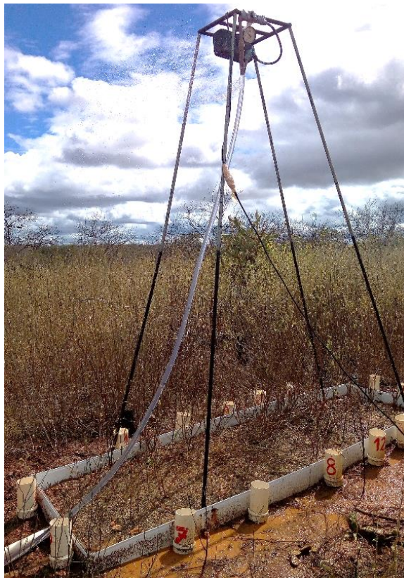
Figura 03. Simulador de chuva, motor, estrutura retangular e manômetro. (Fonte: Cíntia Lins, 2019)
