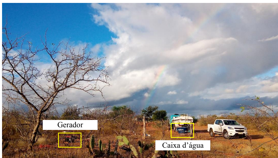
Figura 04. Disposição no campo dos equipamentos utilizados nos testes de simulação de chuvas no Luvissole com cobertura vegetal. (Fonte: Cíntia Lins, 2019)
