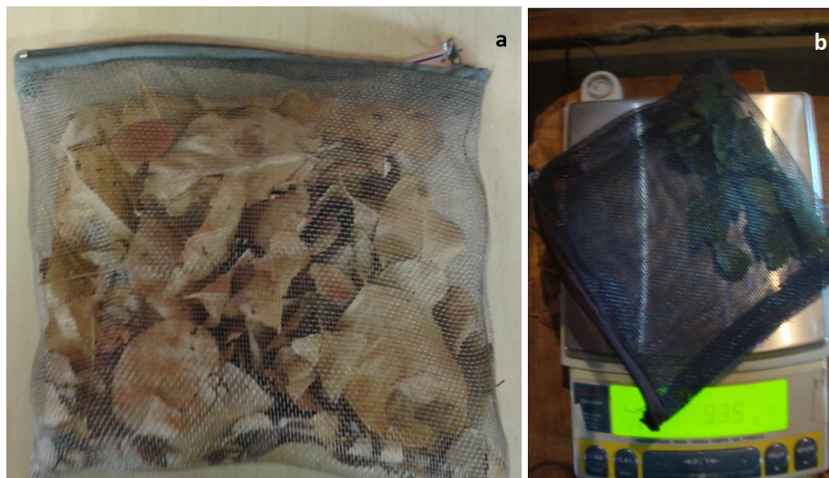
Figura 6. a – Litterbag confeccionada para experimento de decomposição; b – Preenchimento e pesagem das bags com resíduos vegetais
