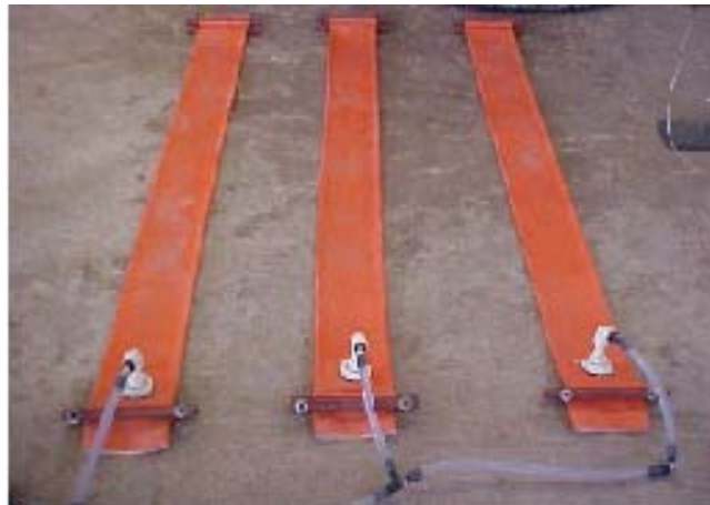
Figura 5. Traveseiros hidráulicos conectados a tubulação de transmissão de fluido. Os traveseiros são presos nas extremidades por presilhas.
