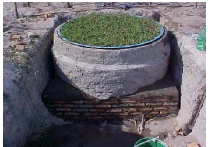
Figura 10. Lisímetro montado em galpão para testes preliminares (esq.); Lisímetro pré-montado em campo, plantado com capim pangola (dir.).
