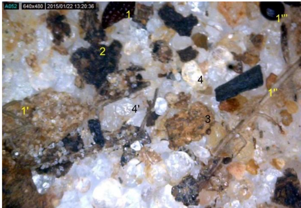
Figura 13. Areia Grossa (Ap) - Neossolo Flúvico (P4): (1) fragmento de carapaça de inseto; (1') folha; (1'') galho; (1''') semente; (2) agregado manganoso; (3) agregado ferroso; (4) quartzo subarredondado; (4') quartzo subanguloso.
