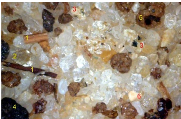
Figura 10. Areia Grossa (2Cnz) - Cambissolo Flúvico (P2): (1) fragmento orgânico; (2) biotita; (3) fragmentos de rochas (quartzo + biotita + feldspato + mineral opaco); (4) agregado manganoso; (5) agregado ferroso; (6) feldspato. Observar quartzo ao fundo, ocorrendo em grão subarredondados a arredondados.
