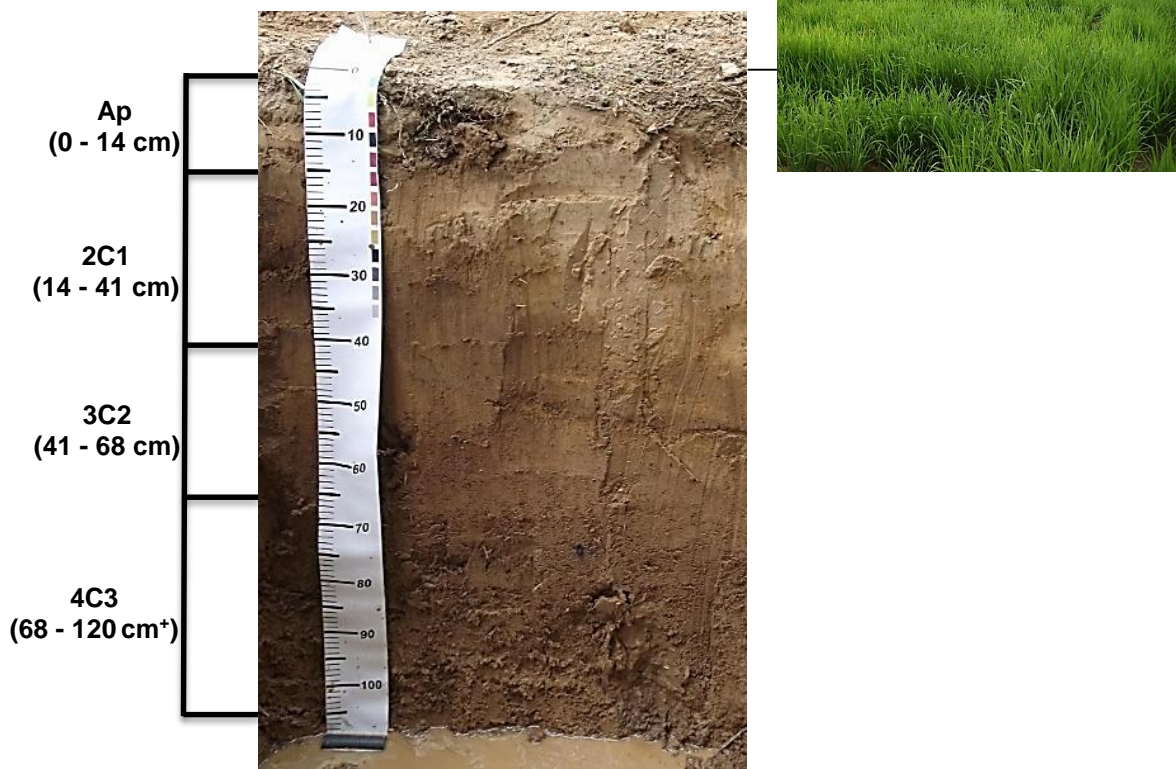
Figura 6. Distribuição e classificação dos horizontes do NEOSSOLO FLÚVICO (P4) e sua paisagem no transecto na Ilha de Assunção, Cabrobó-PE.
