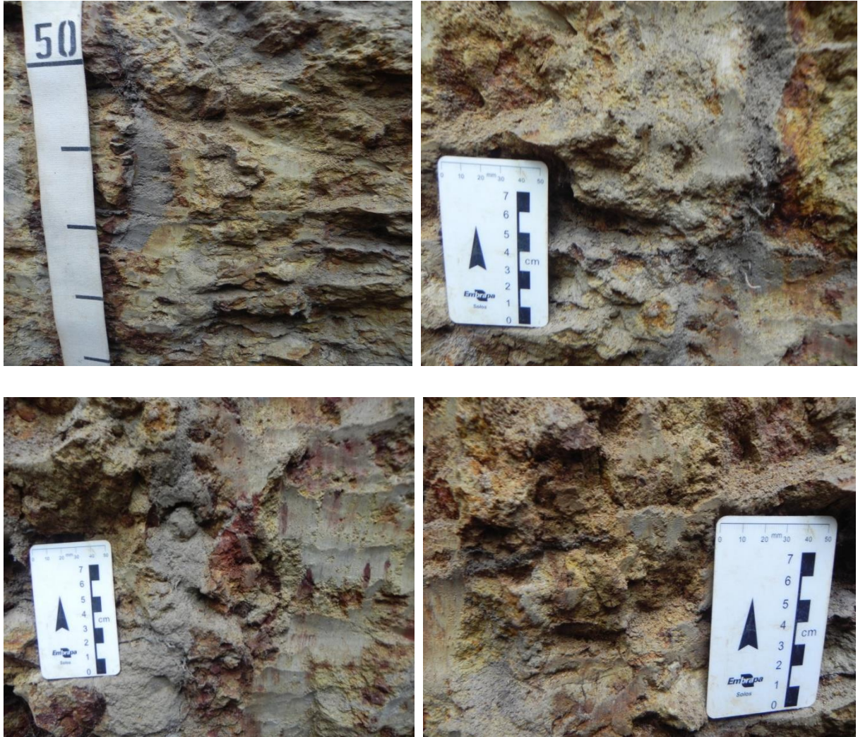
Figura 7. Processo de cimentação em horizontes com caráter dúrico na região da Paraíba
