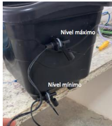
Figura 3. Detalhe de níveis eletrônicos usados para limitar o volume da solução nutritiva nos contêineres
