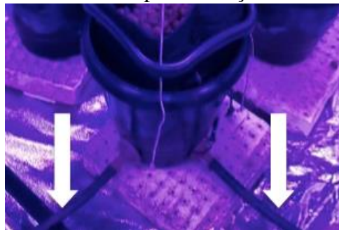
Figura 6. Detalhe da conexão entre vasos por tubulação flexível
