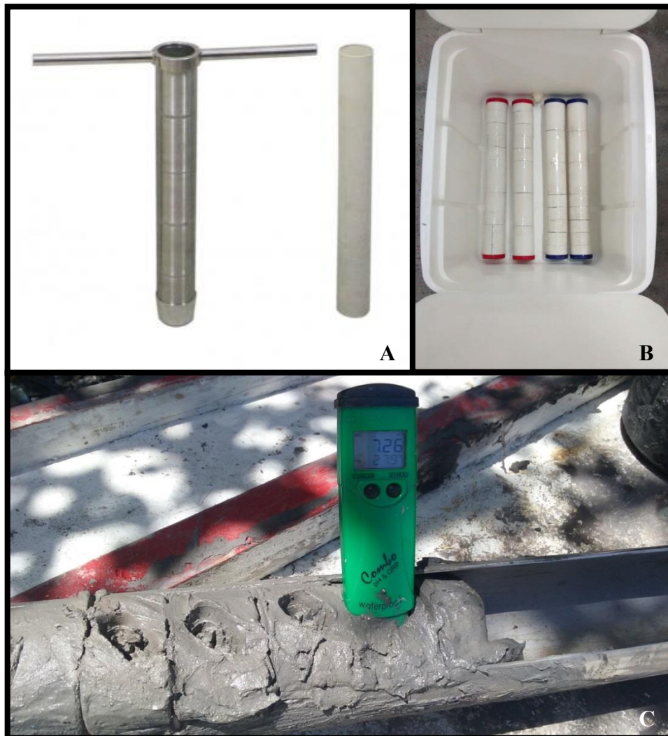
Figura 4.2. Amostrador específico para solos inundados (trado “josefina”) (A); armazenamento das amostras de solo em caixas térmicas na posição vertical (B); determinação de pH e Eh no campo a cada profundidade do perfil (C)
