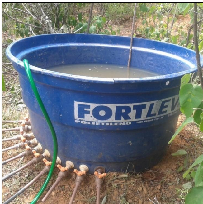
Figura 14 - Reservatório (sob carga constante) de água utilizado para gerar o escoamento concentrado, e os registros para controle dos diferentes níveis de vazão
