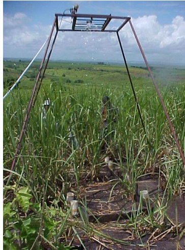
Figura 3.2. Vista geral do simulador de chuva e da parcela experimental no campo com a cultura da cana de açúcar no 3º mês de estágio fenológico.
