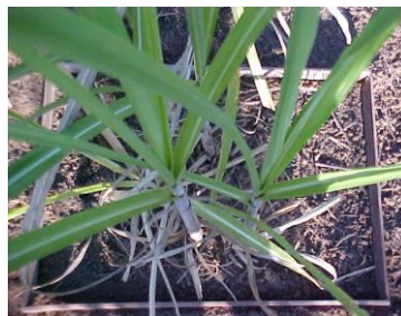
Figura 3.5. Vista aérea da moldura de madeira utilizada para determinação da taxa de cobertura do solo pelo método de Mannering (efeito isolado do dossel).
