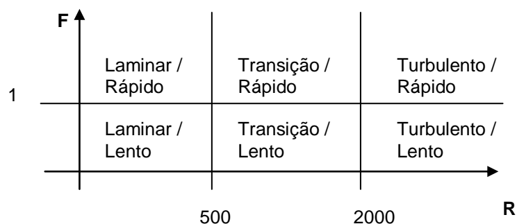
Figura 3.4. Esquema de classificação dos regimes de escoamentos gerados durante as simulações de chuva.
