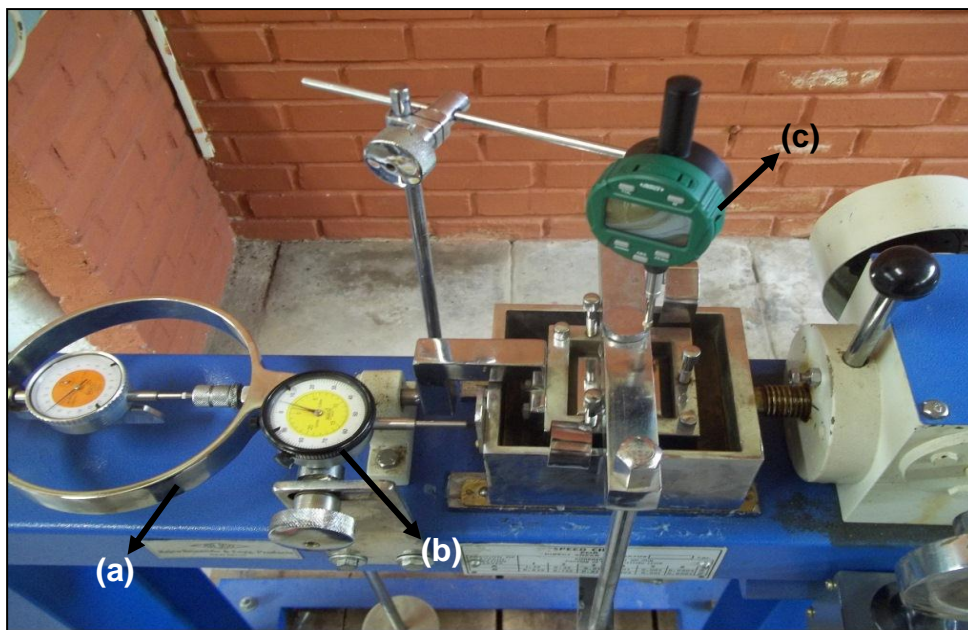
Figura 20 - Conjunto de anéis comparadores de deformações.
