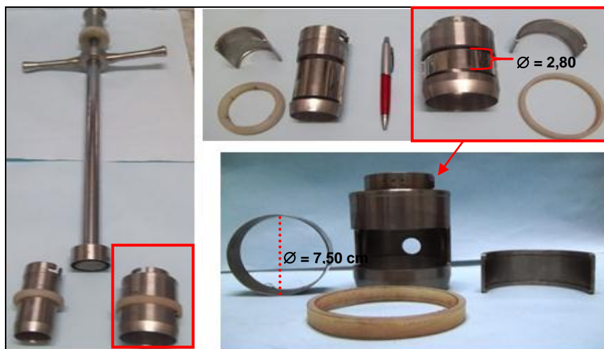
Figura 11 - Adaptação do amostrador de Uhland (vermelho).
