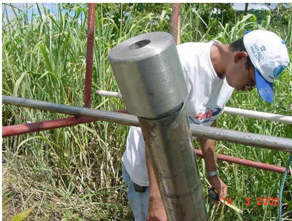
Figura 8 – Batedor para acoplamento do martelo ao tubo de encamisamento.
