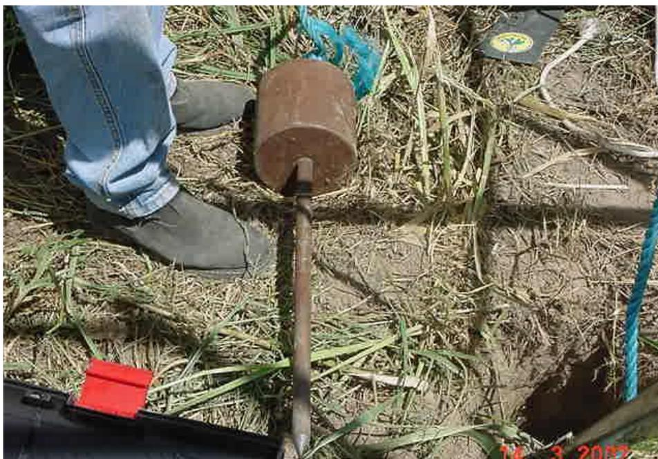
Figura 7 – Martelo para instalação do piezômetro por impacto.
