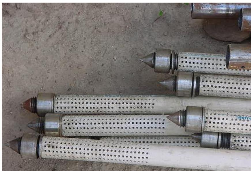
Figura 6 – Piezômetros e tubos de ferro de encamisamento.
