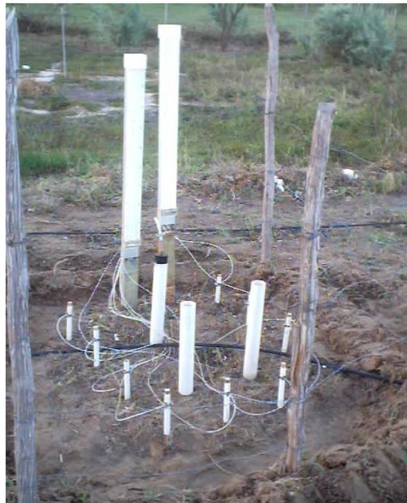
**Figura 8** – Estação Tensiométrica.
