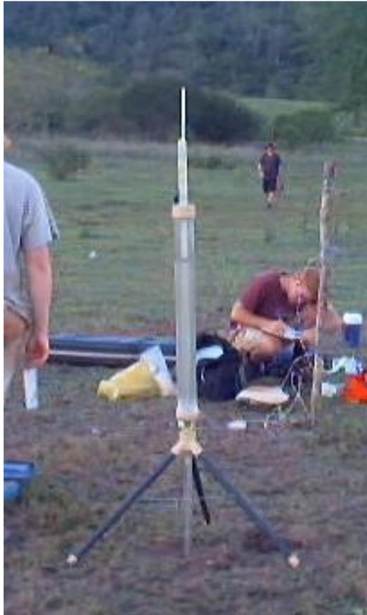
*Figura 6- Permeômetro de Guelph, montado no campo.*
