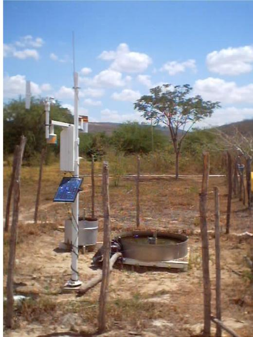
*Figura 4 – Estação Meteorológica completa e Tanque Classe “A”*
