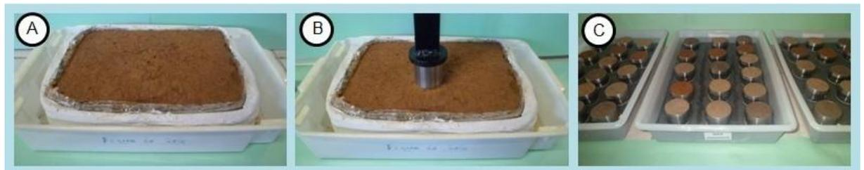
**Figura 5.** Etapas de obtenção de amostras: (a) condicionamento dos blocos não deformados; (b) coleta de amostras na forma de anéis volumétricos.
