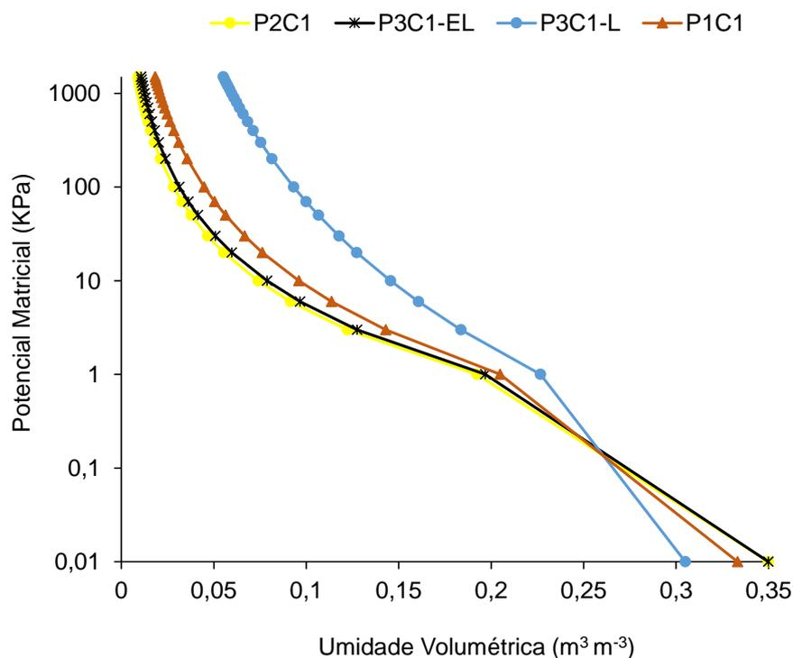
Figura 14. Curvas de retenção dos horizontes com lamelas (P1C<sub>1</sub>, P2C<sub>1</sub> e P3L) e entre lamela do P3, localizados no município de São João-PE.
