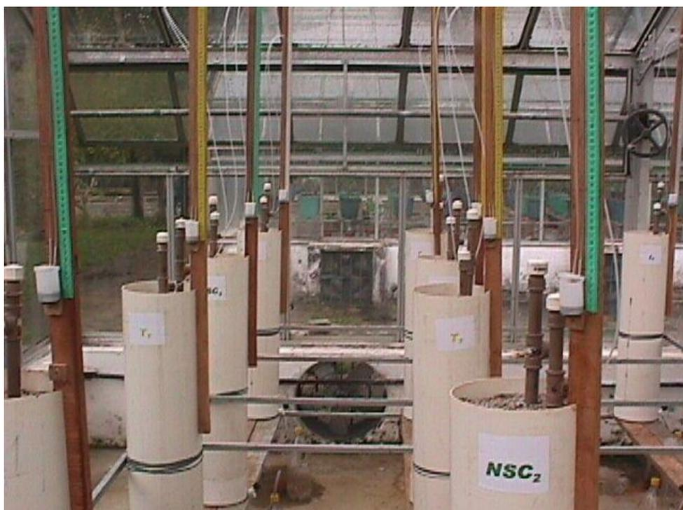
Figura 1. Vista dos tensiômetros após confecção e instalação nas colunas
