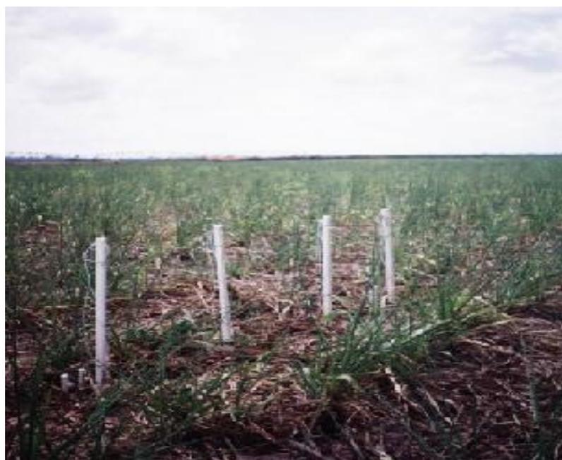
Figura 5: Bateria de tensiômetros em campo para monitoramento.
