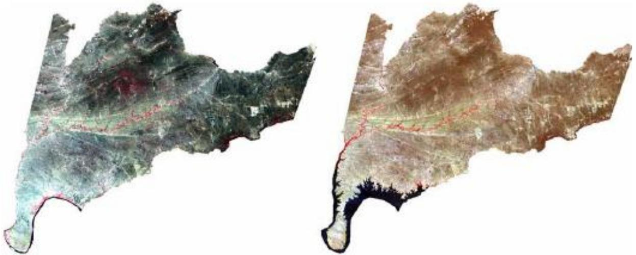
**Figura 3.7.** Composição colorida em R4G3B2 – Imagens do sensor TM/LANDSAT 5 de outubro de 1987 e do sensor ETM<sup>+</sup>/LANDSAT 7 de setembro de 1999 respectivamente com correção radiométrica.
