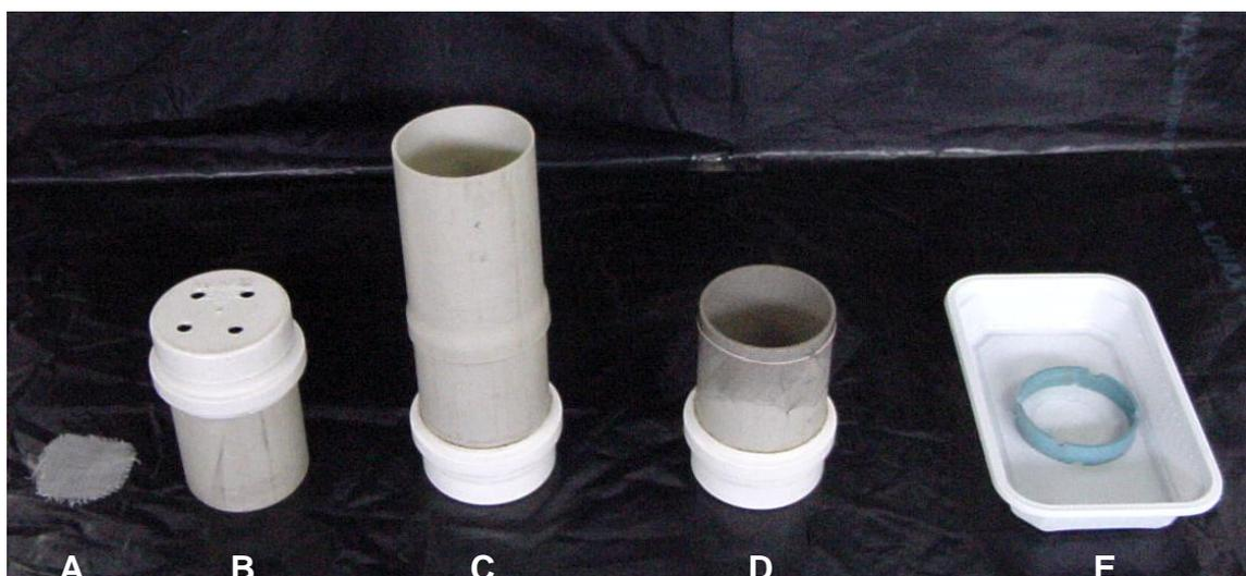
Figura 2: Materiais utilizados para determinação da densidade global, porosidade total efetiva, capacidade de aeração e de recipiente.
