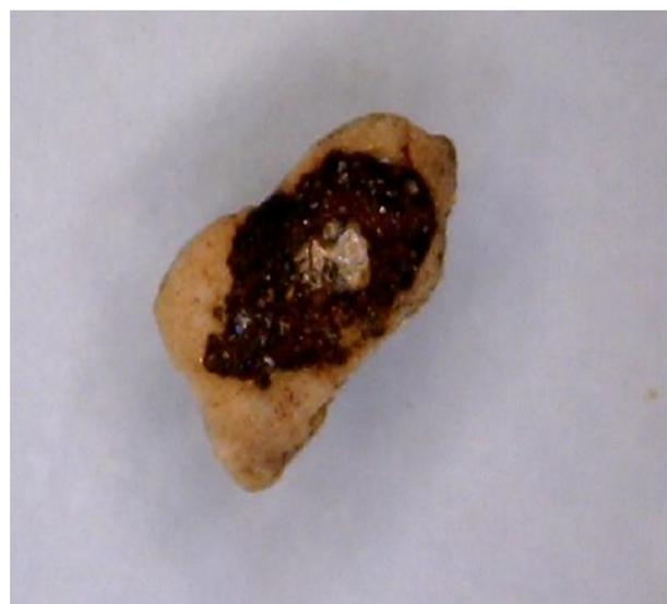
**Figura 37** – Grão de feldspato em vias de alteração com incrustações de óxido de ferro, presente na fração areia grossa do horizonte Bt do perfil de Altinho.
