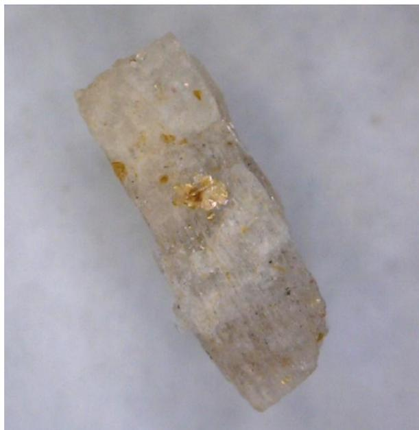
**Figura 35** – Grão de feldspato com sinais de alteração, presente na fração areia grossa do horizonte BC do perfil de Altinho.
