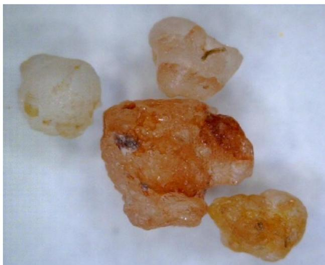
**Figura 41** – Grãos de quartzo subarredondados com incrustação de óxido de ferro, presente na fração areia grossa do horizonte Bt do perfil de Arcoverde.
