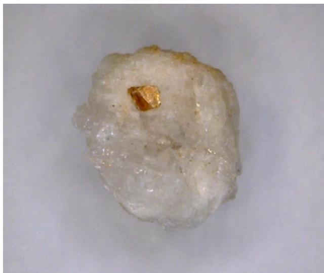
**Figura 39** – Grão de quartzo com incrustação de biotita, presente na fração areia grossa do horizonte Bt do perfil de Altinho.
