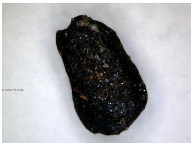
**Figura 30** – Agregados manganoso, presente na areia grossa do horizonte A do perfil de Altinho.
