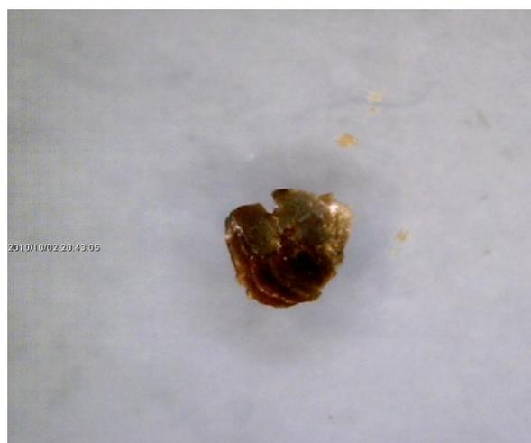
**Figura 31** – Grão de biotita em processo de alteração, presente na areia grossa do horizonte A do perfil de Altinho.
