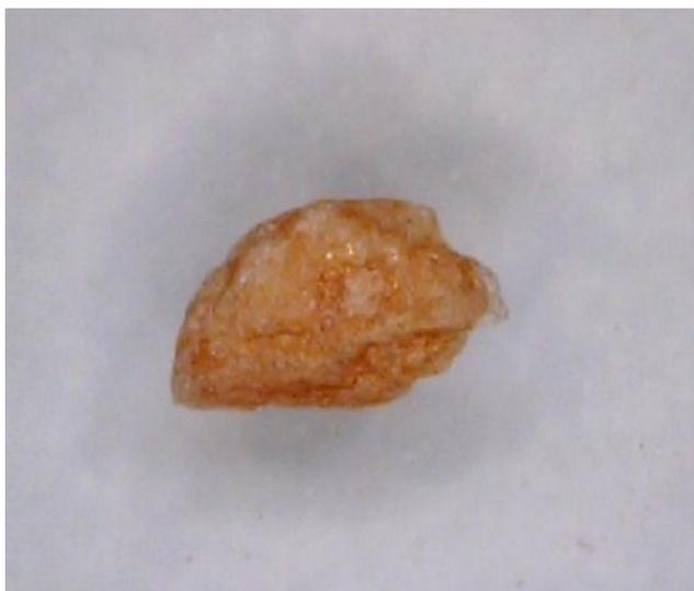
**Figura 38** – Grão de feldspato róseo em vias de alteração, presente na fração areia grossa do horizonte Bt do perfil de Altinho.
