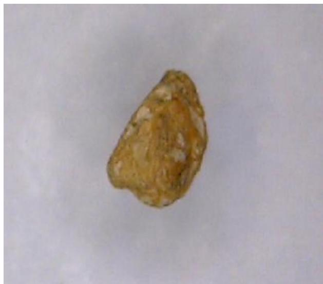
**Figura 36** – Agregados argiloso, presente na fração areia grossa do horizonte Bt do perfil de Altinho.
