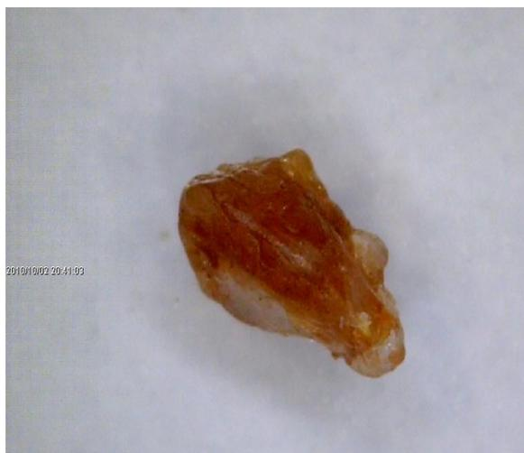
**Figura 33** – Grão de quartzo subarredondado com incrustações de óxido de ferro, presente na areia grossa do horizonte A do perfil de Altinho.
