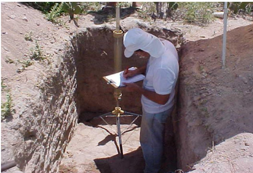
Figura 7 Permeâmetro de Guelph montado no campo (perfil1).
