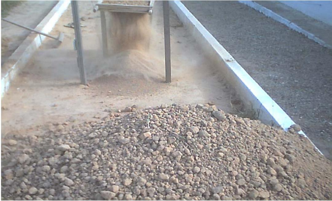
**Figura 3.** Processo de tamização do material de solo.
