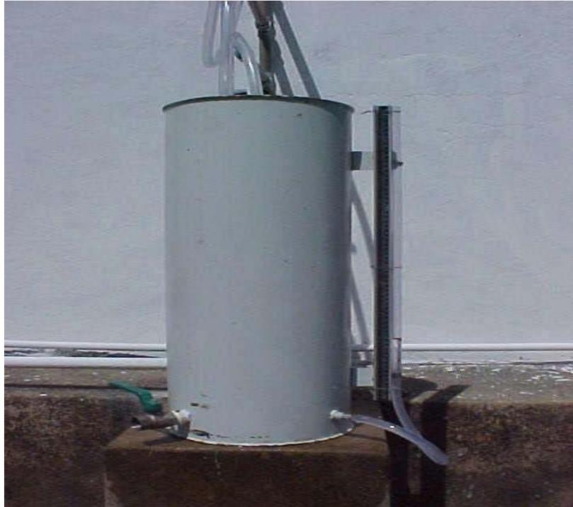
**Figura 5.** Cilindro coletor com piezômetro previamente calibrado.
