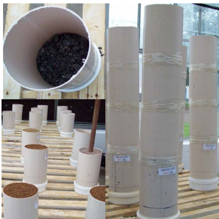
Figura 1. Detalhes das colunas de PVC, e do preenchimento das mesmas.
