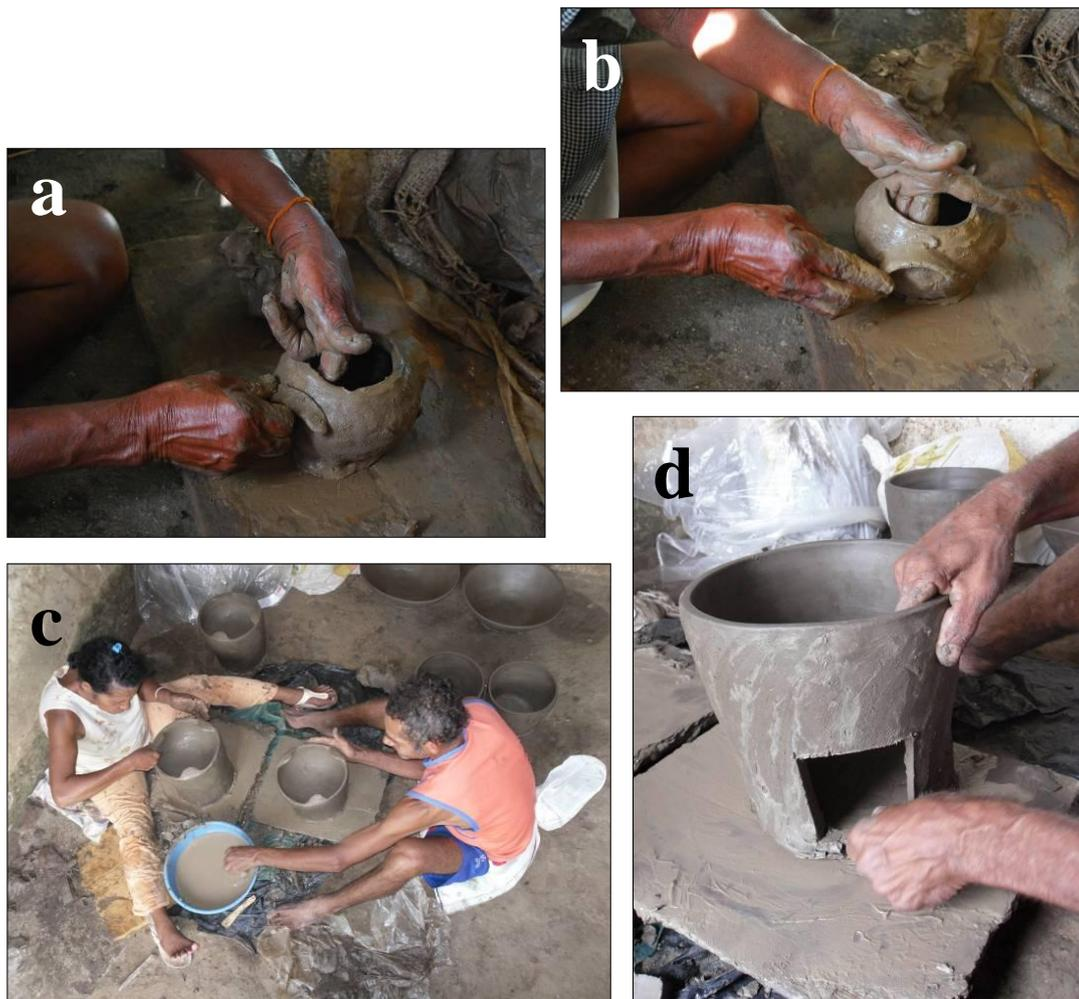
**Figura 13.** Ceramistas acrescentando estruturas aos vasos (a) Acréscimo da “asa” à panela;(b) Ajuste da “asa” ao corpo da panela; (c) Preenchimento do “fogareiro” e aplicação das abas (d) Abertura quadrada no “fogareiro”. Fotos: (a) (b) Sérgio Bernardo e (c) e (d) Ângelo Alves
