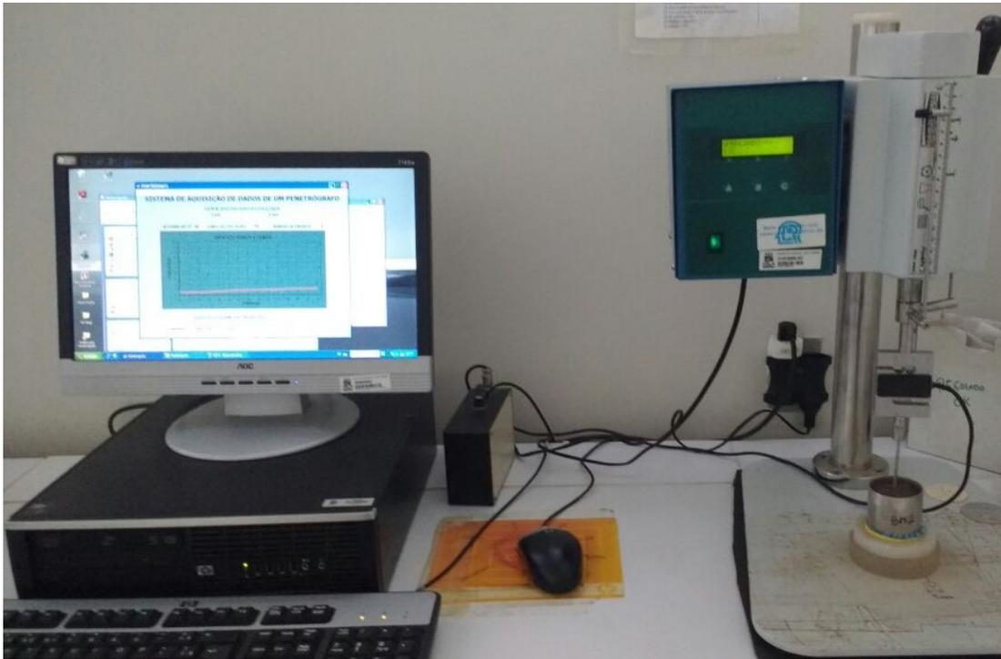
**Figura 13:** Penetrômetro eletrônico de bancada
